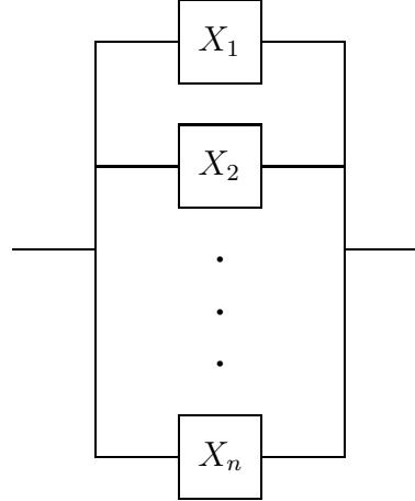
Systemet funksjonerer så lenge minst en av komponentene funksjonerer. Levetiden til systemet blir  $V = \max(X_1, X_2, \dots, X_n)$ .
