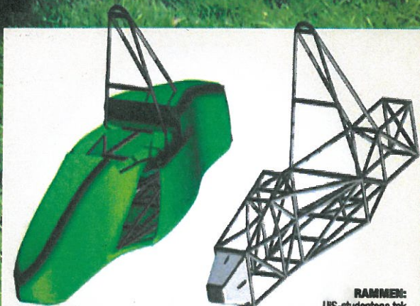
KAROSSERIET – Skallet er laget med tanke på å få minst mulig luftmotstand, og at luftinntaket på sidene skal brukes til å kjøle ned motor. Dette er en enkel og «ren» body, uten for mange vanskelige vinkler og kurver, forklarer de.
