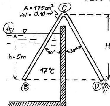
Ein tank er fylt med ei ideell og inkompressibel væske med samme tettleik og damptrykk som vatn, og temperatur  $20^{\circ}\text{C}$ . Den skal tömmast med ein hevert, som vist på figuren. Begge beina til heverten er like lange og med same skråvinkel,  $30^{\circ}$ . Det indre tverrsnittet til heverten er  $175 \text{ cm}^2$  overalt, og det indre volumet til den er  $0.40 \text{ m}^3$ .
